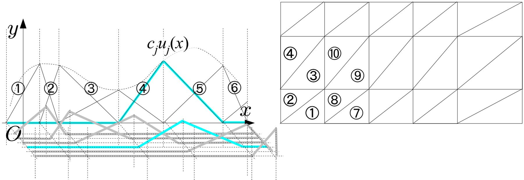
折れ線関数  $u_1, \dots, u_n$  に重み  $c_1, \dots, c_n$  をかけて近似する
