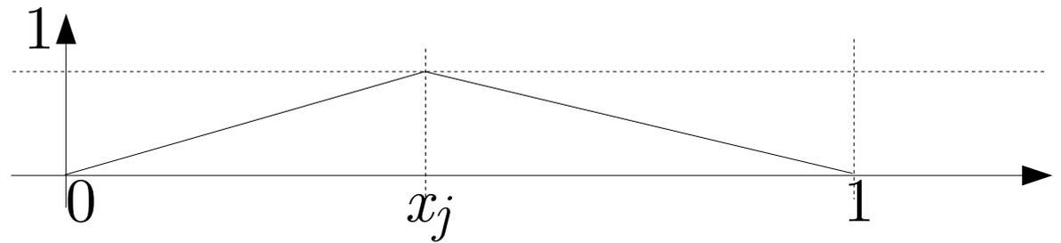
※  $x_0, \dots, x_N$  (節点)、 $f_0, \dots, f_N$  (節点での関数値) を使う
