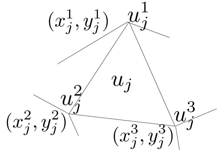
$$\begin{bmatrix} \alpha_j \\ \beta_j \\ \gamma_j \end{bmatrix} = \begin{bmatrix} x_j^1 & y_j^1 & 1 \\ x_j^2 & y_j^2 & 1 \\ x_j^3 & y_j^3 & 1 \end{bmatrix}^{-1} \begin{bmatrix} u_j^1 \\ u_j^2 \\ u_j^3 \end{bmatrix} = A_j^{-1} U_j$$
