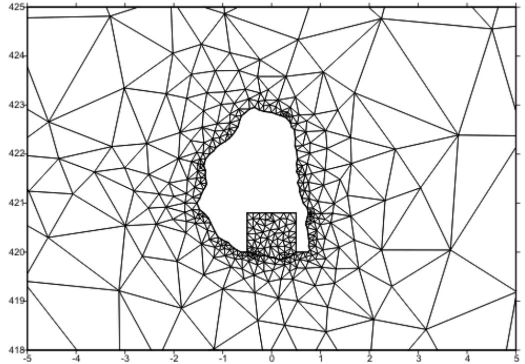
三角形による二次元平面・二次元曲面の有限要素分割
